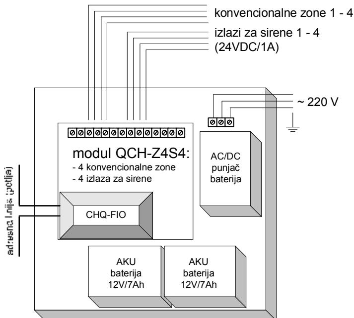
Za proračun parametara adresene linije (petlje) relevantni su samo parametri modula **CHQ-FIO (1 po modulu QCH)**, dok se ostali elementi QCH kao i prateći ulazni i ulazni elementi sagledavaju samo u kontekstu lokalnog kućišta i napajanja.
