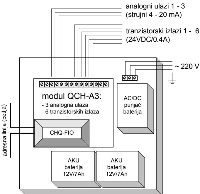
Za proračun parametara adresene linije (petlje) relevantni su samo parametri modula **CHQ-FIO (1 po modulu QCH)**, dok se ostali elementi QCH kao i prateći ulazni i ulazni elementi sagledavaju samo u kontekstu lokalnog kućišta i napajanja.
