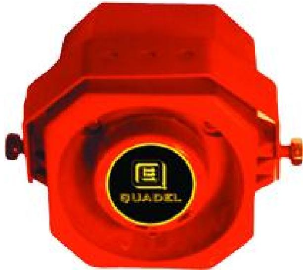
QAS je elektrodinamička sirena namenjena uzbunjivanju u slučaju dojave požara. Predviđena je za unutrašnju montažu (na zid, pomoću metalnog držača). Za slučaj spoljne montaže potrebno je obezbediti zaklon od neposrednog uticaja atmosferskih padavina.
